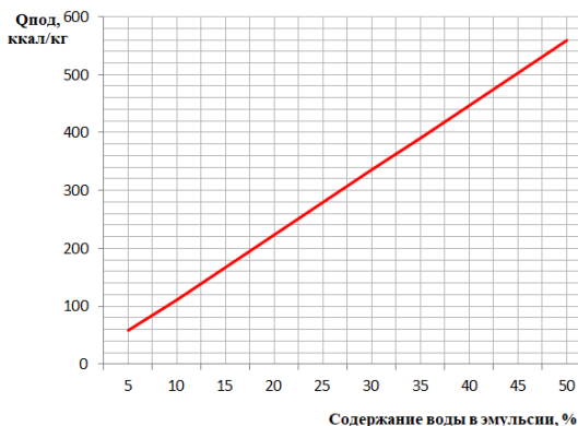
Рис. 1. Зависимость количества теплоты на подогрев воды от процентного содержания воды в ВМЭ
